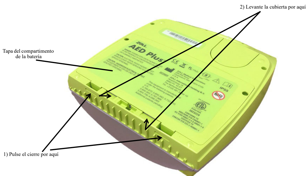
Figura 7: Retirada de la tapa del compartimento de la batería
